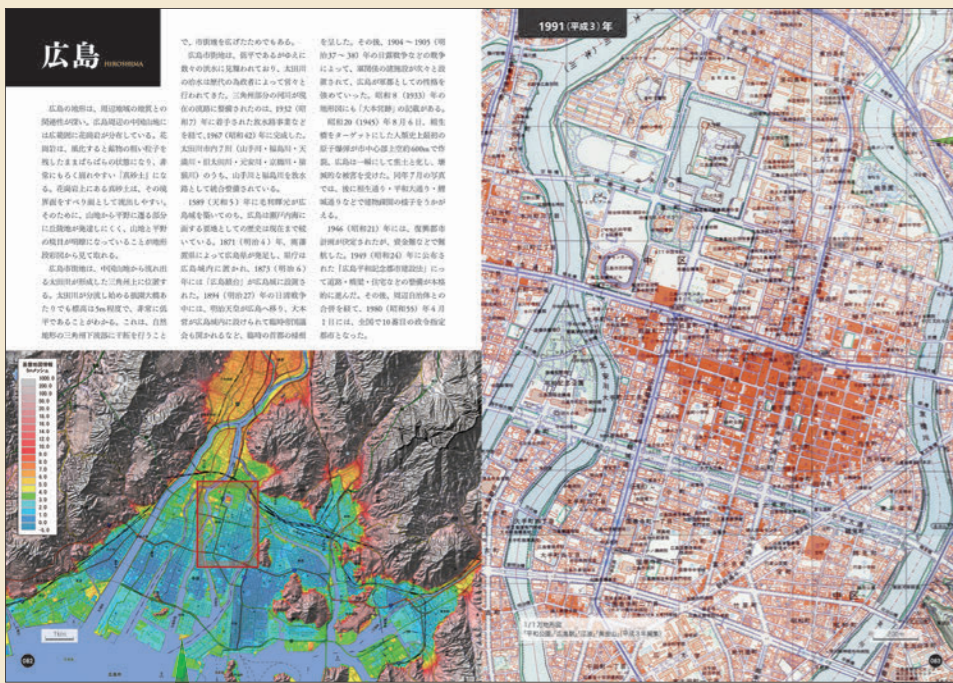
〈地形段彩図〉 地理院地図（ウェブ地図最新版）＋基盤地図情報（5mメッシュ標高【一部、10mメッシュ標高】を使用）で作成。
